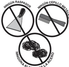
**AVISO:** Evite el uso de compuestos de limpieza abrasivos, limpiadores a base de cloruro o limpiadores que contengan sales cuaternarias. **Nunca** use ácido clorhídrico (ácido muriático) en acero inoxidable.
