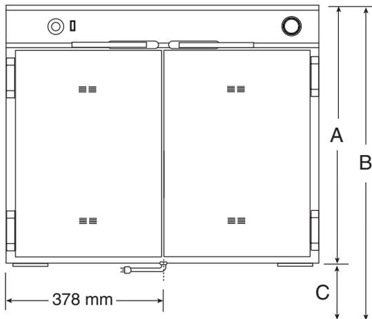
Raccordement électrique en bas, à 41 mm de l'arrière
