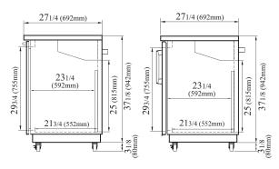
TBB-4SBD-N & TBB-4SGD-N SIDE VIEW
